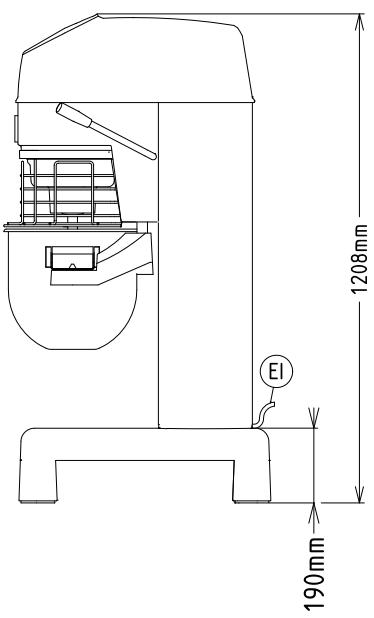
**EI** = Conexión eléctrica (energía)
